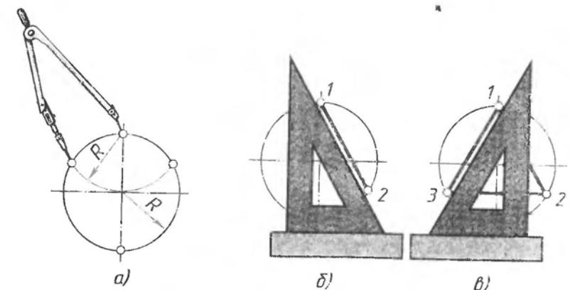
Рис. 126. Деление окружности на три равные части:
