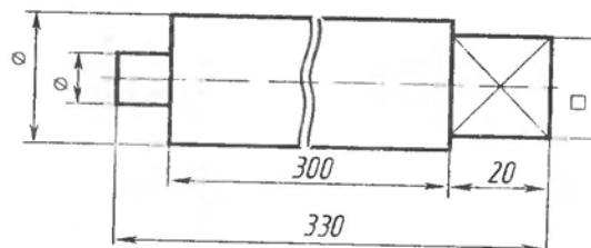
Рис. 204. Условности и упрощения: сокращение количества и размера изображений
