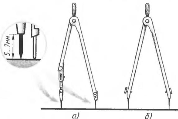
Рис. 11. Циркуль чертежный: а — круговой; б — разметочный
