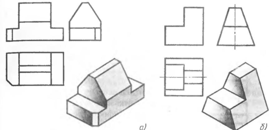
Рис. 88. Изображение элементов поверхности детали
