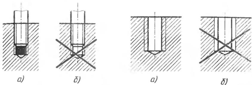
Рис. 220. Изображение шпильки, ввинченной в отверстие с резьбой:
