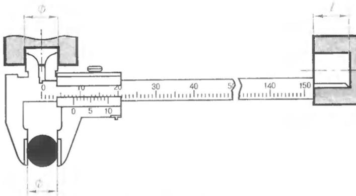
Рис. 153. Измерения штангенциркулем
