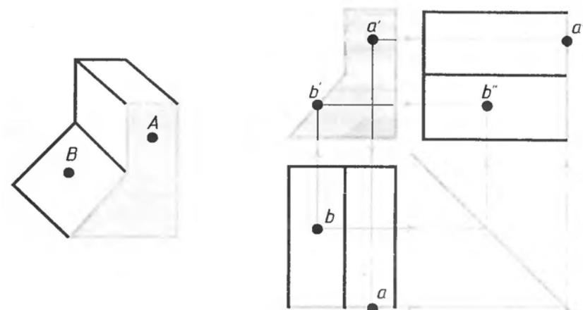
Рис. 93. Построение проекций точки, лежащей на поверхности предмета
