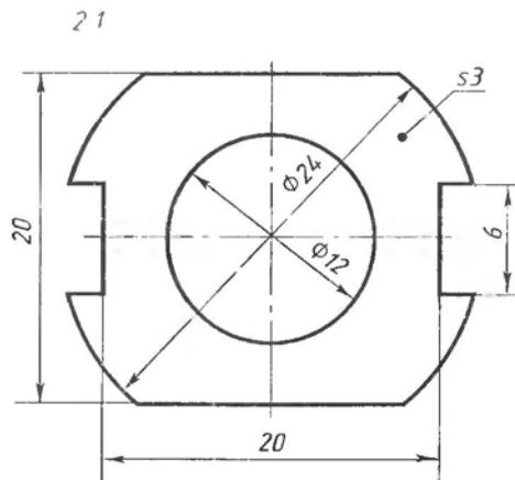
Рис. 35. Чертеж прокладки, выполненный в различных масштабах
