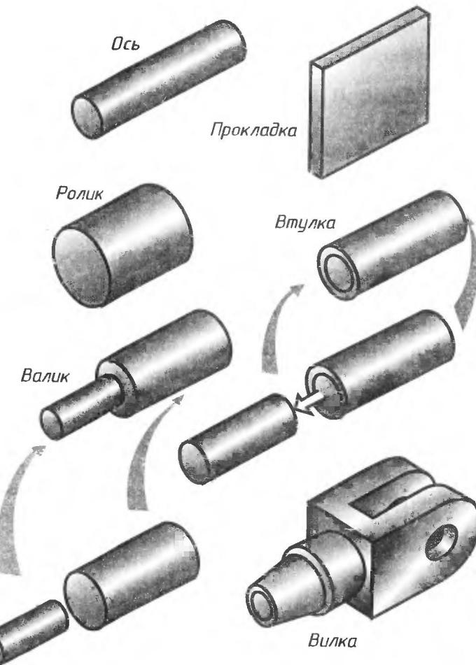
Рис. 73. Различные детали имеют в своей основе геометрические тела
