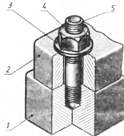
Рис. 218. Шпилечное соединение
