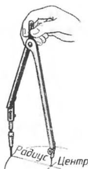
Рис. 16. Проведение окружности циркулем
