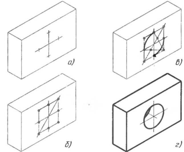
Рис. 68. Построение изометрической проекции детали с цилиндрическим отверстием
