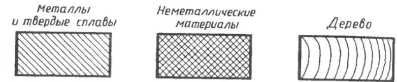
Рис. 198. Некоторые графические обозначения материалов
