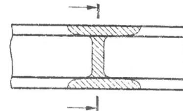
Рис. 172. Обозначение наложенного несимметрического сечения
