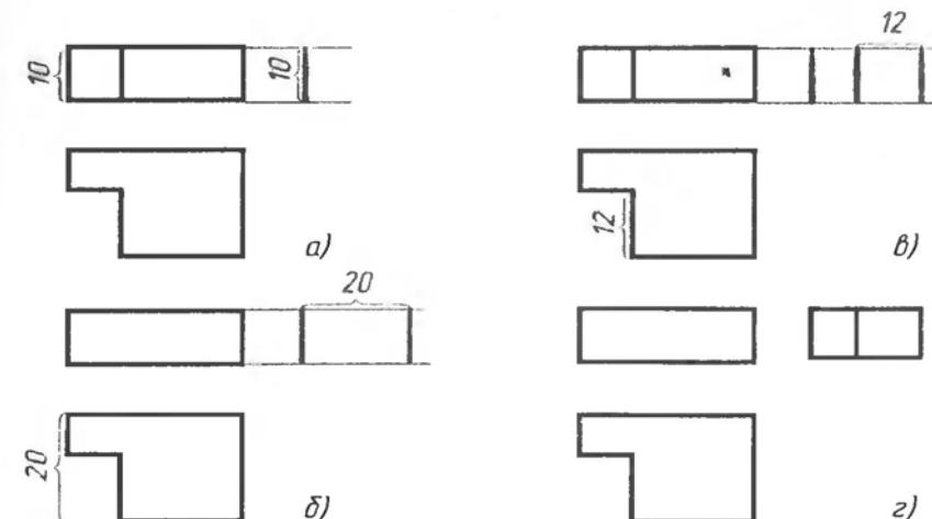
Рис. 109. Построение третьей проекции
