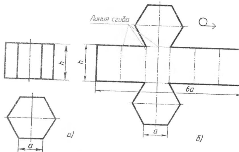
Рис. 139. Построение чертежа развертки поверхностей призмы:
