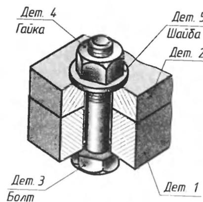
Рис. 216. Болтовое соединение
