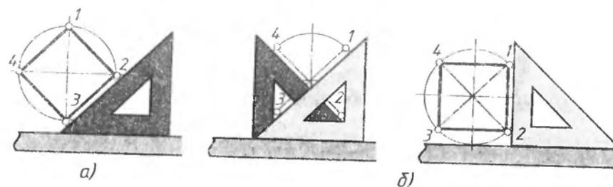
Рис. 124. Деление окружности на четыре равные части
