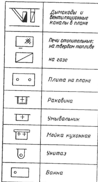
Рис. 264. Отопительные и санитарно-технические устройства
