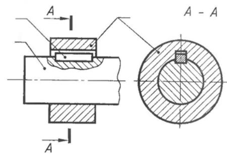
Рис. 225. Сборочный чертеж шпоночного соединения:
