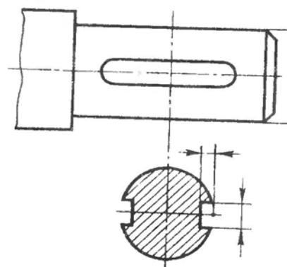
Рис. 175. Пример нанесения размеров на сечении
