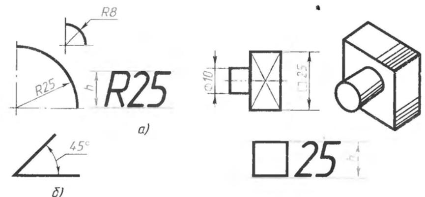
Рис. 31. Нанесение размеров дуг и угла
