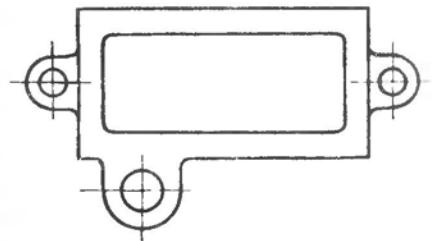
Рис. 191. Соединение части вида и части разреза
