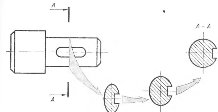
Рис. 173. Совмещение сечения с плоскостью чертежа
