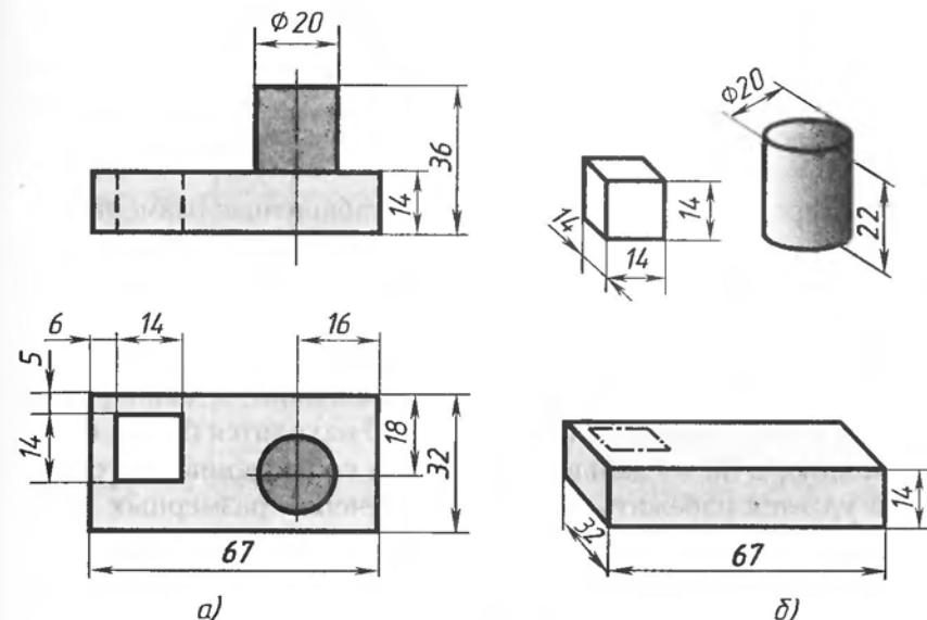
Рис. 116. Нанесение размеров
