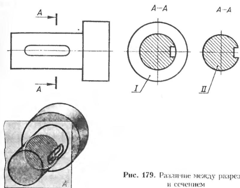
Рис. 179. Различие между разрезом и сечением
