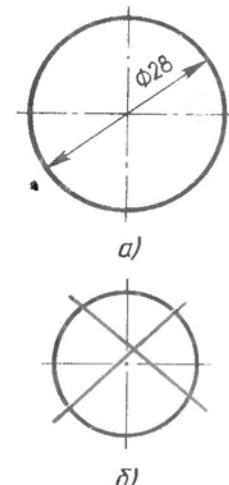
Рис. 22. Проведение центральных линий:
