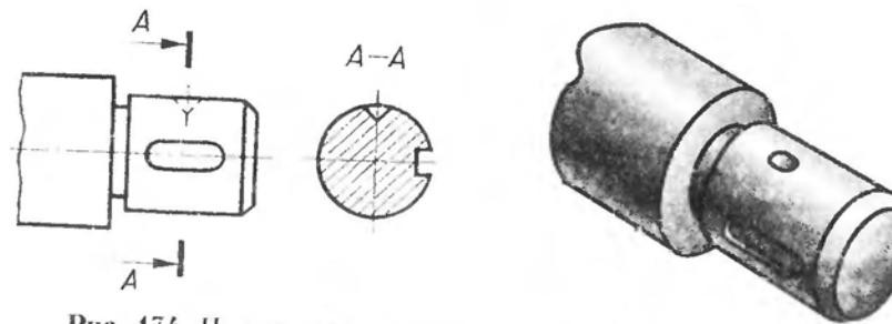
Рис. 174. Пример сечения, на котором контур конического углубления показан полностью
