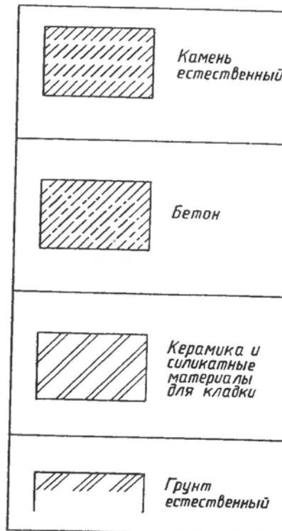
Рис. 265. Графические обозначения материалов в сечениях
