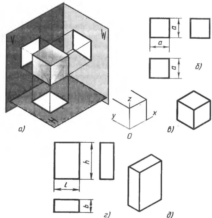
Рис. 76. Куб и прямоугольный параллелепипед:
