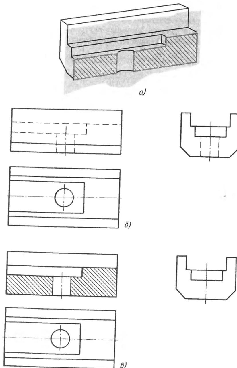
Рис. 178. Построение разреза
