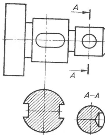
Рис. 170. Вынесенные сечения
