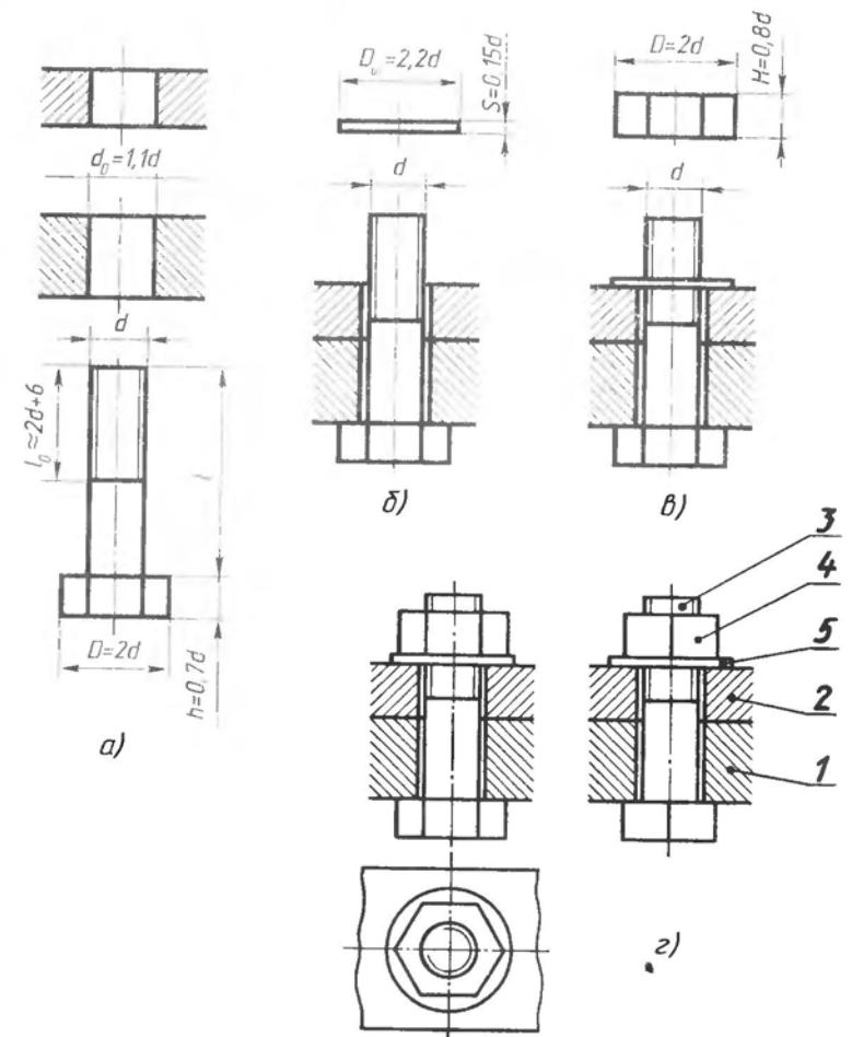
Рис. 217. Упрощенное изображение болтового соединения
