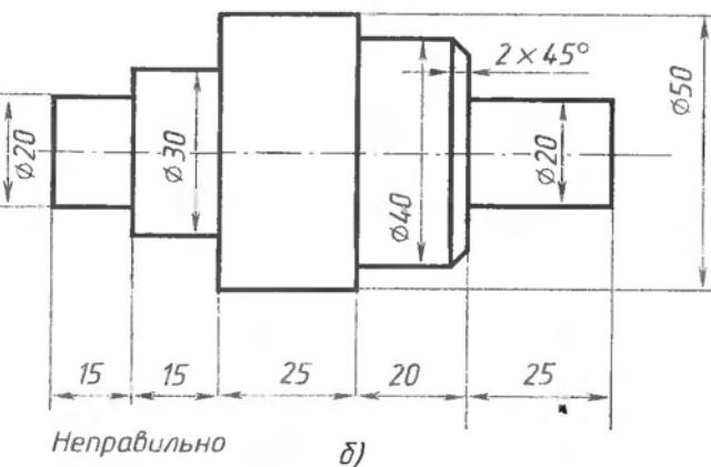
Рис. 117. Нанесение размеров
