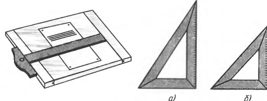
Рис. 12. Чертежная доска и рейсшина
