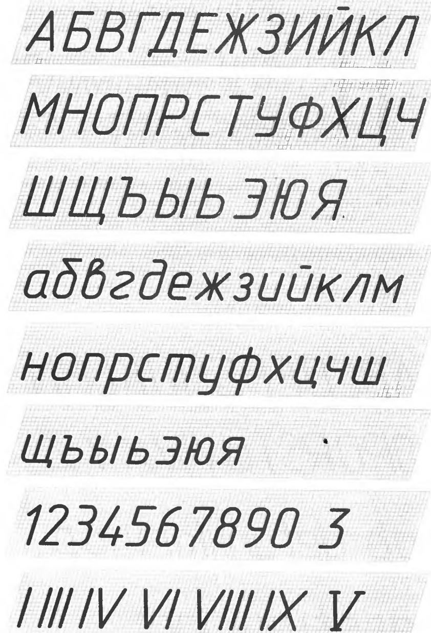
Рис. 25. Буквы и цифры чертежного шрифта
