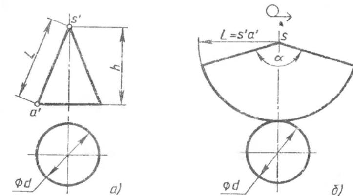
Рис. 141. Построение чертежа развертки поверхностей конуса:
