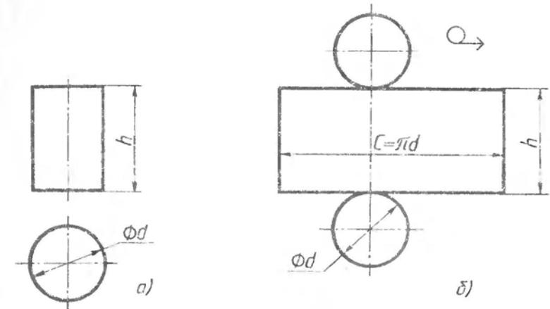
Рис. 140. Построение чертежа развертки поверхностей цилиндра:
