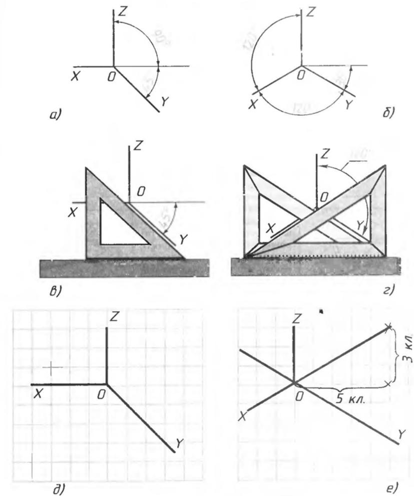
Рис. 61. Изображение осей аксонометрических проекций:
