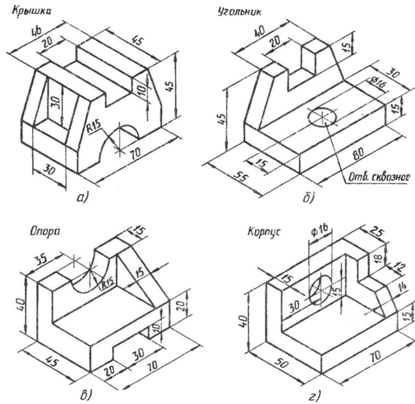
Рис. 160. Задания к графической работе № 11
