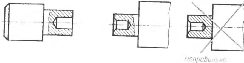
Рис. 189. Построение местного разреза
