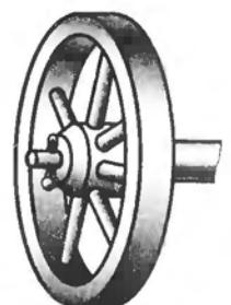
Рис. 208. Простейшее соединение колеса и оси повозки
