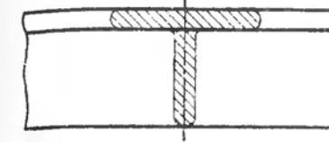
Рис. 171. Наложенное симметрическое сечение
