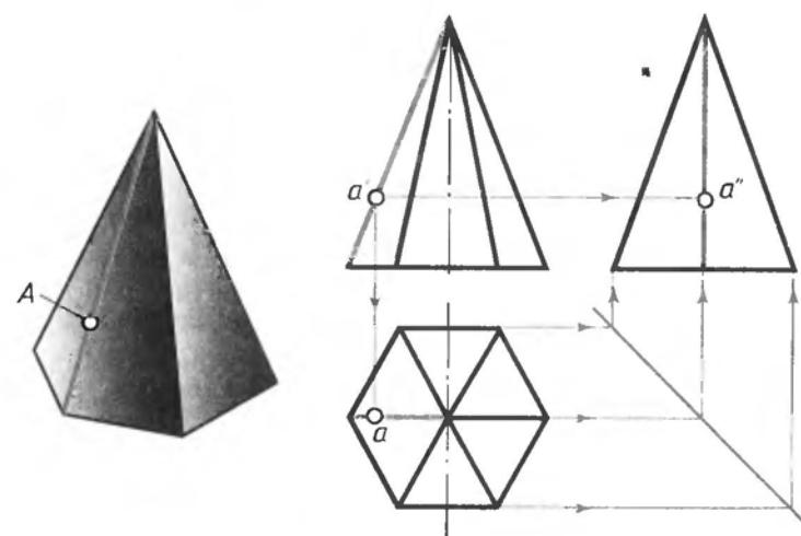
Рис. 91. Построение проекции точки, лежащей на ребре пирамиды
