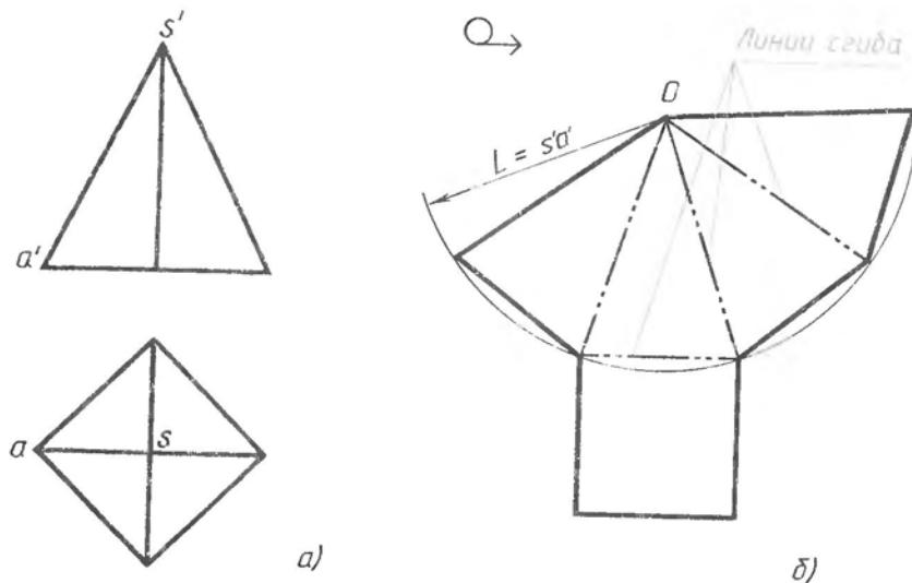
Рис. 142. Построение чертежа развертки поверхностей пирамиды:
