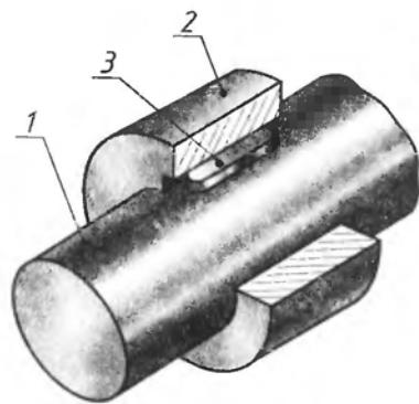
Рис. 223. Соединение шпонкой
