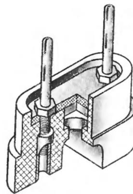
верстие в средней части корпуса 1, поджимается прокладкой 3 и крепится гайкой 5 на штыре 4. Контакты 2 предназначены для крепления штырей 4 и позволяют подключать сверху еще одну вилку.
