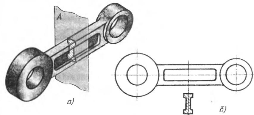
Рис. 169. Сечение: а – получение; б – изображение
