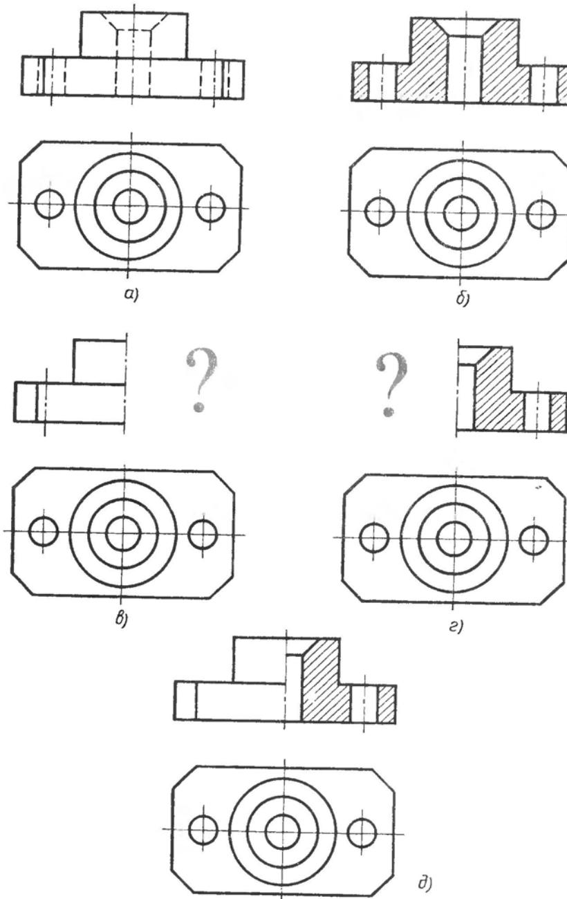
Рис. 192. Соединение половины вида и половины разреза
