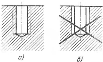
Рис. 221. Штриховка на изображении отверстия с резьбой: а — правильно;
