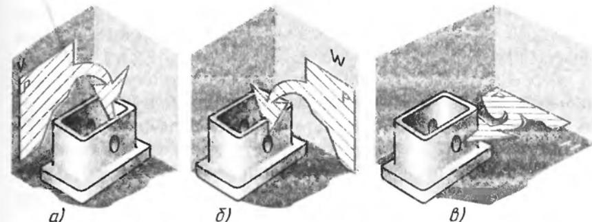
Рис. 181. Положение секущей плоскости при выполнении разрезов
