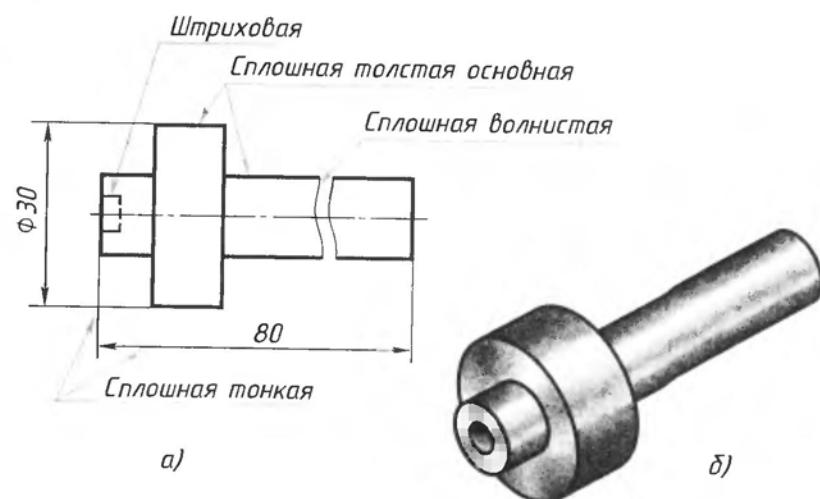
Рис. 21. Линии чертежа
