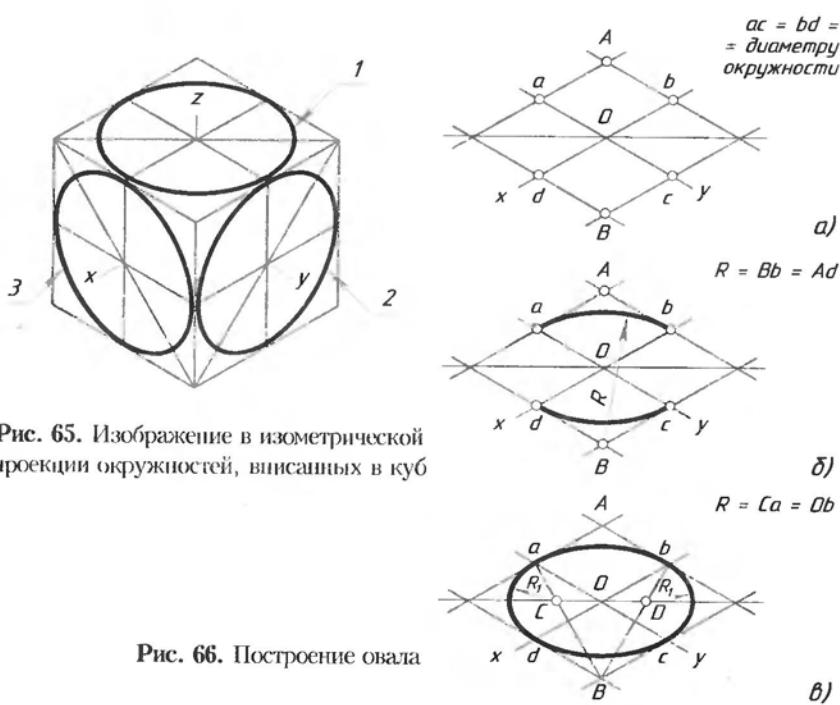
Рис. 65. Изображение в изометрической проекции окружностей, вписанных в куб
