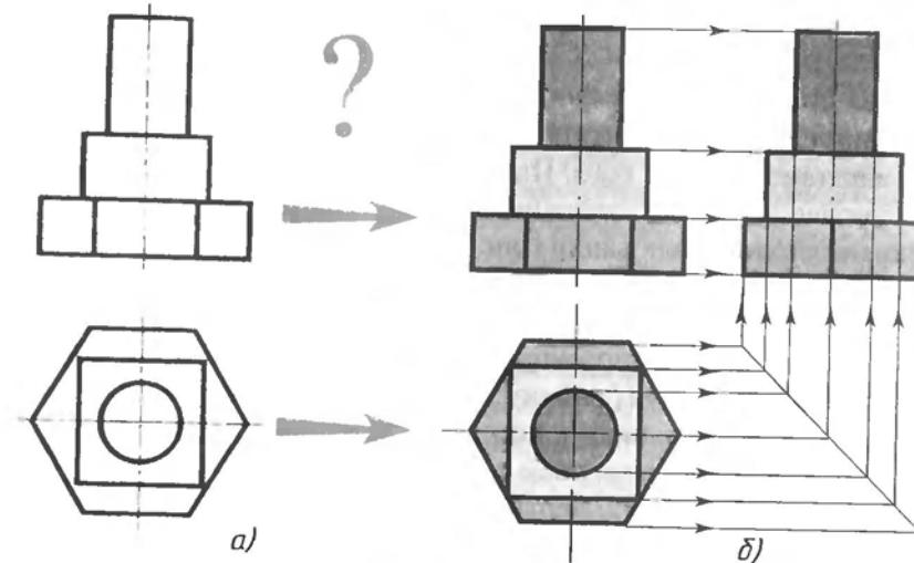
Рис. 110. Построение третьей проекции по двум данным
