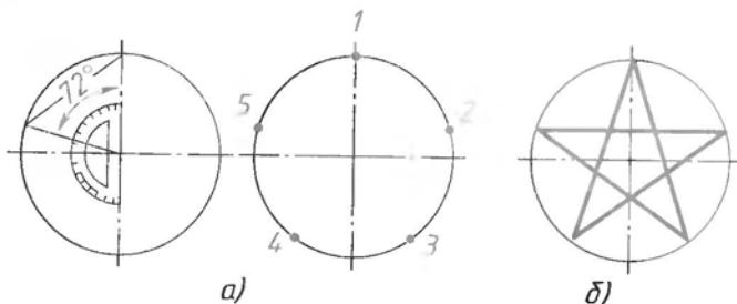
Рис. 129. Деление окружности на пять равных частей
