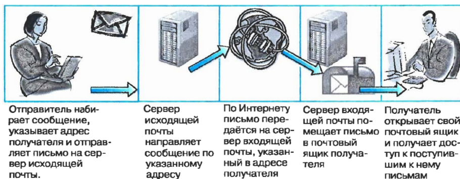
Рис. 6.6. Схема работы электронной почты
